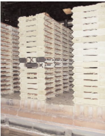
Фото 6б Промышленные испытания Aptalite. Помеченные кассеты из Aptalite среди стандартных ИКФ-кассет на печной вагонетке.
