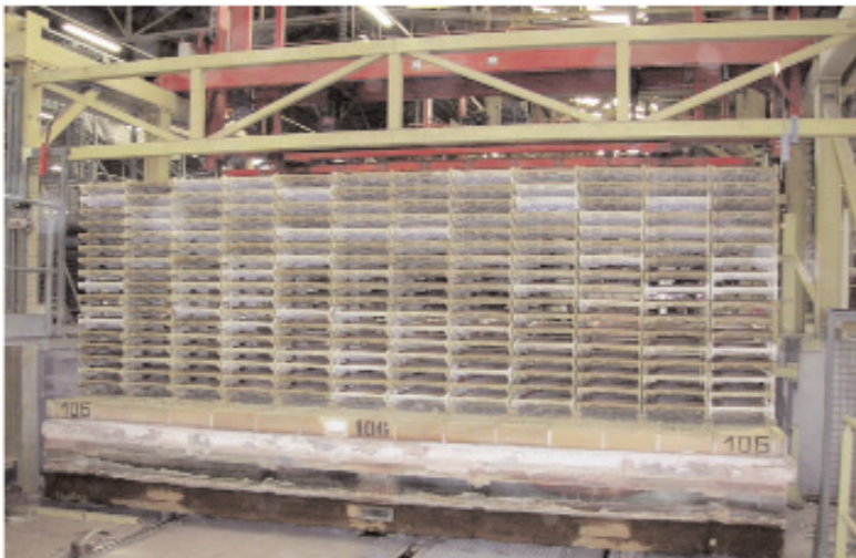
Фото 6а Промышленные испытания Aptalite. Кассеты из Aptalite (белого цвета), в произвольном порядке установленные на печную вагонетку.
